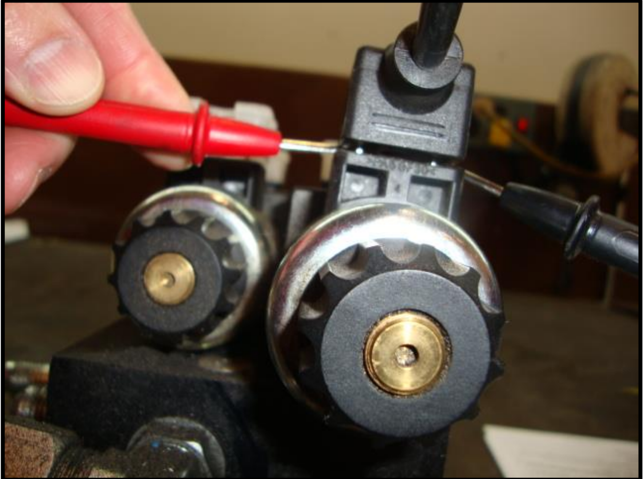
Fig. 8-2 Checking Din Plug Voltage
