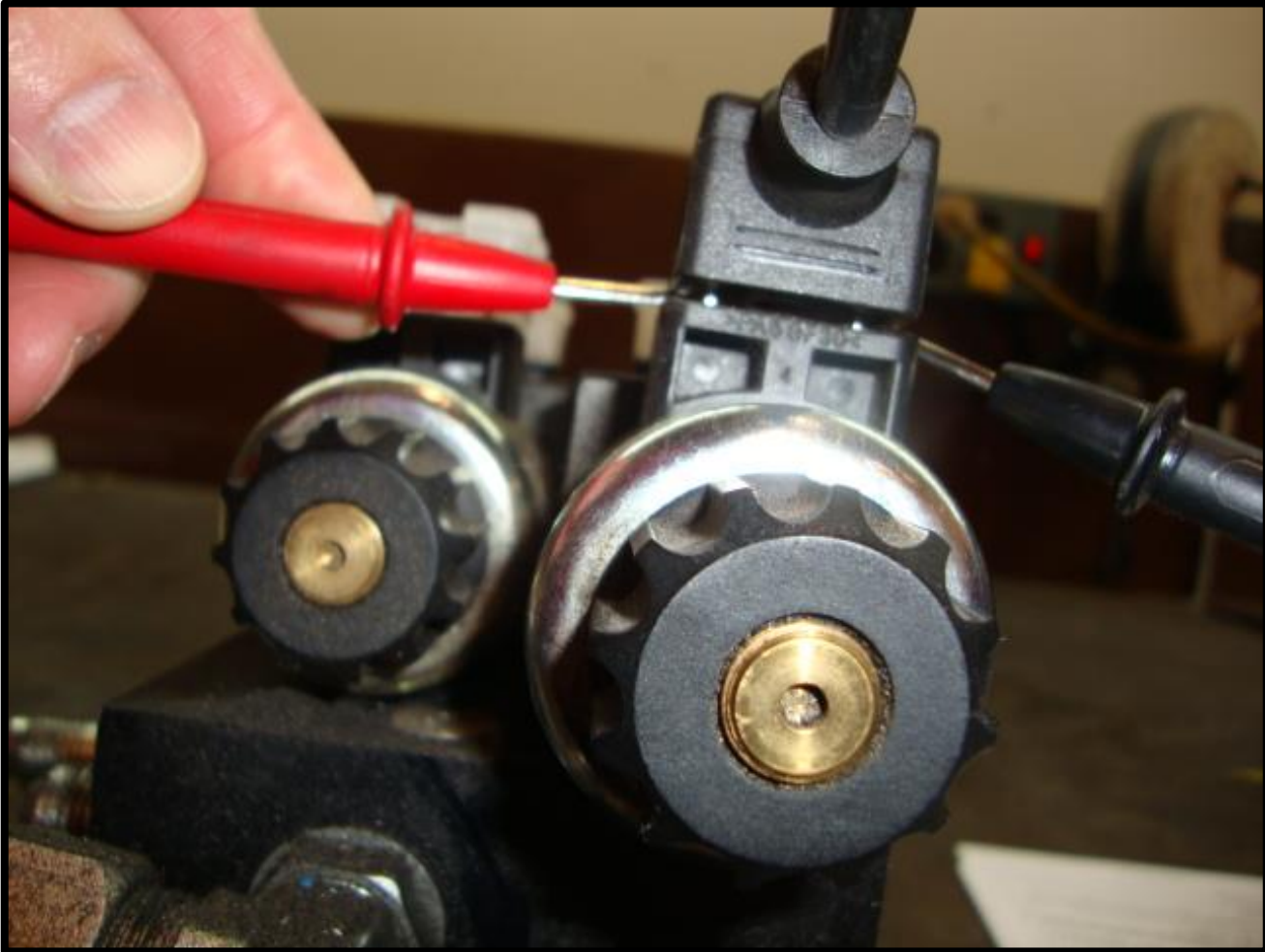
Fig. 8-4 Checking Din Plug Voltage
