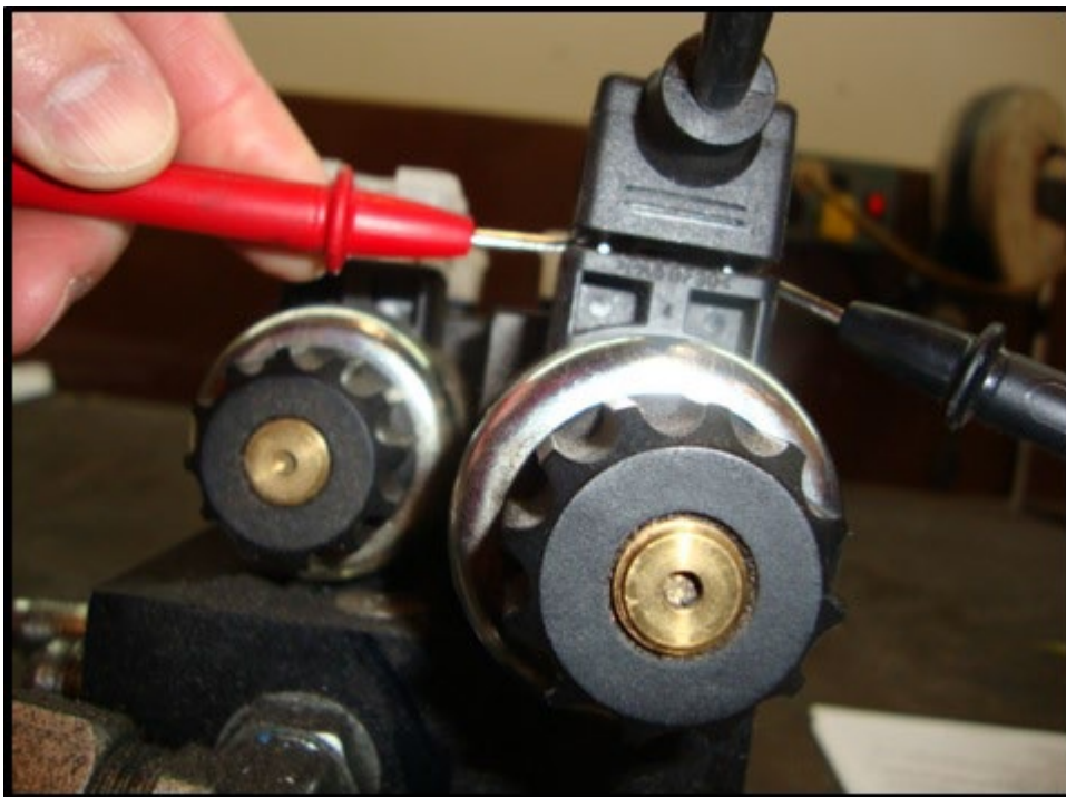
Figure 8-4 Checking Din Plug Voltage
